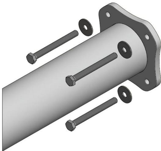
**8.** Auf vier Sechskantschrauben M10x100 (10) jeweils eine Unterlegscheibe M10 (9) drauf schieben und die Sechskantschrauben M10x100 (10) durch die Bohrungen des Flansches stecken.
