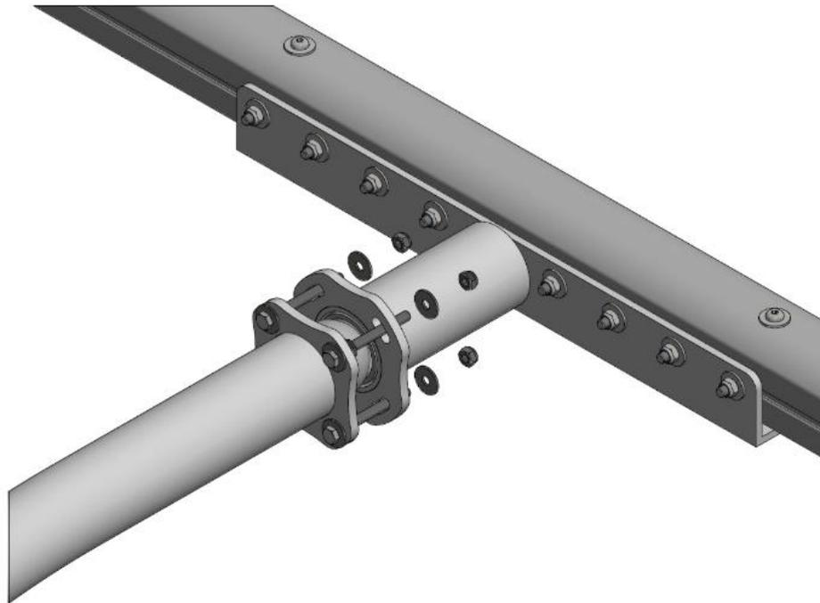
**11.** Den Lattenhalter (4) wiederum mit weiteren vier Unterlegscheiben M10 (9) und Sechskantmuttern M10 (12) sichern.
