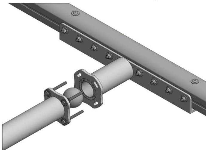
**10.** Die Kugel (13) zwischen Lattenhalter (4) und Mast (1) platzieren und den Lattenhalter auf die herausstehenden Sechskantschrauben M10x100 drauf schieben.
