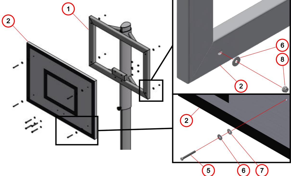
3. Das Zielbrett (2) an den Masten (1) mit vier Linsenkopfschrauben M8x80 (5), acht Unterlegscheiben M8 (6), vier Polyamid-Scheiben M8 (7) und vier Sechskantmuttern M8 (8) verschrauben
