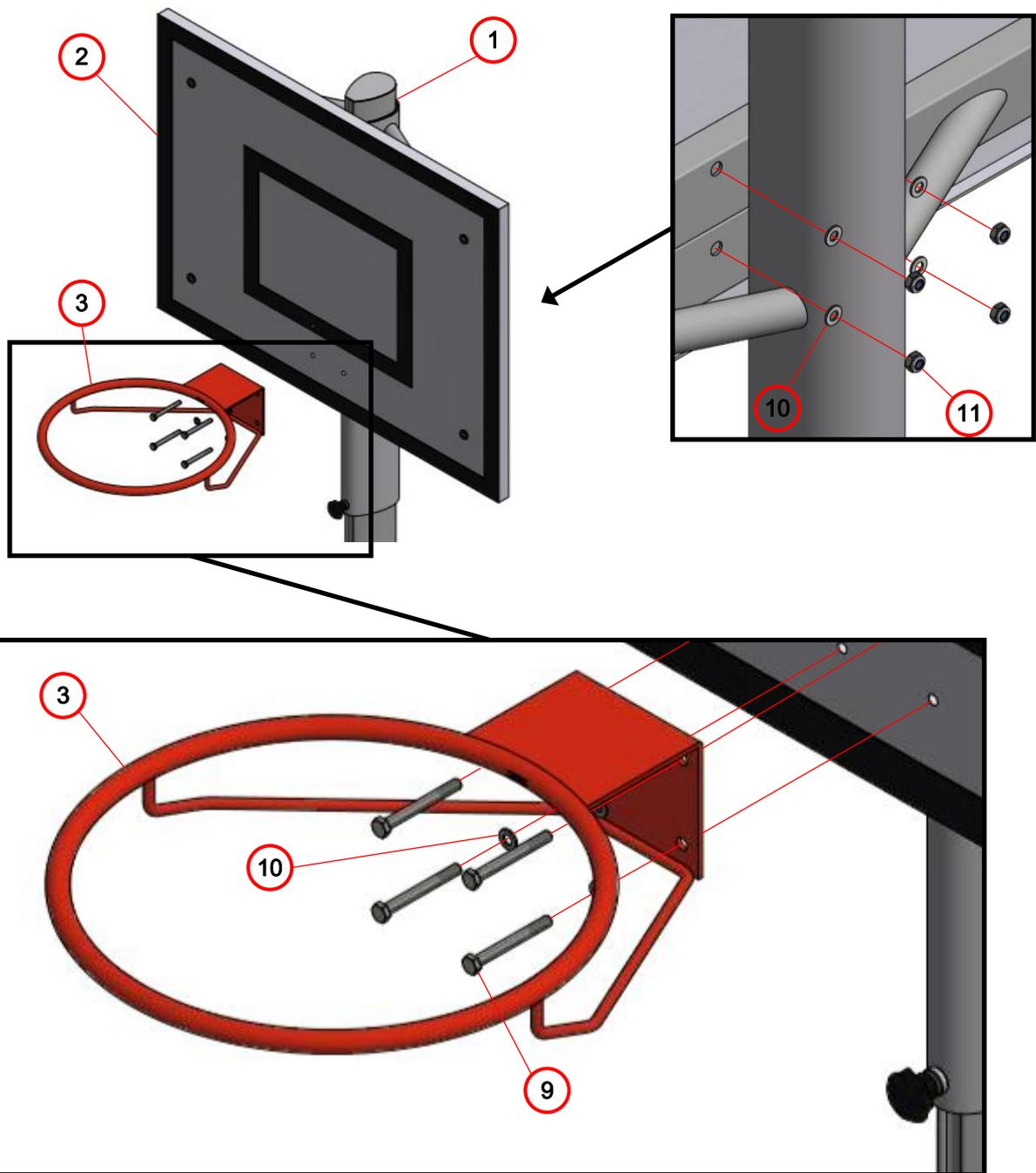
4. Den Basketball-Korb (3) an das Zielbrett (2) mit vier Sechskantschrauben M10x90 (9), acht Unterlegscheiben M10 (10) und vier Sechskantmutter M10 (11) verschrauben.
