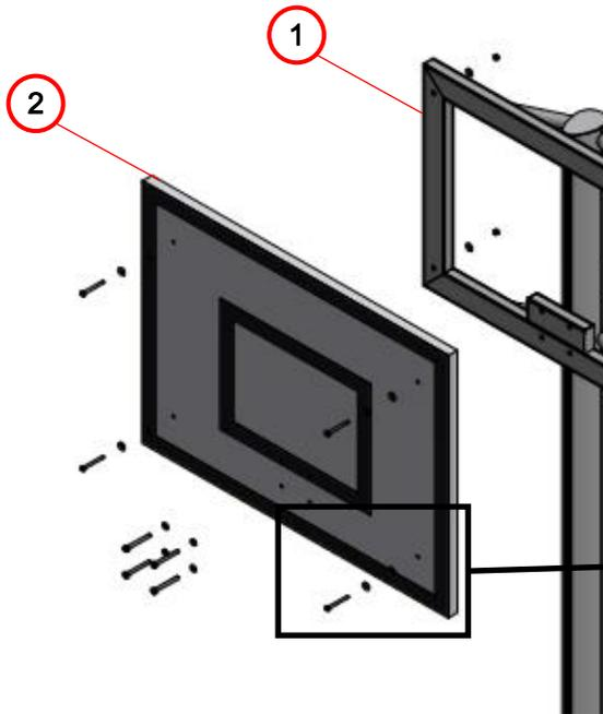
3. Das Zielbrett (2) an den Masten (1) mit vier Linsenkopfschrauben M8x80 (5), acht Unterlegscheiben M8 (6), vier Polyamid-Scheiben M8 (7) und vier Sechskantmuttern M8 (8) verschrauben
