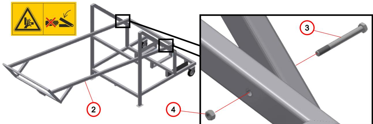
2. Das Korbgerüst (2) durch die unteren Anschraubpunkte an das Untergerüst (1) befestigen. Dafür die Sechskantschraube M12x120 (3) und die Sechskantmutter M12 (4) verwenden.
