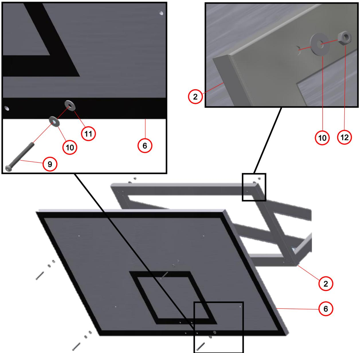
**3.** Das Zielbrett (6) an das Korbgerüst (2) mit vier Linsenkopfschrauben M8x90 (9), acht Unterlegscheiben M8 (10), vier Polyamid-Scheiben M8 (11) und vier Sechskantmuttern M8 (12) verschrauben.
