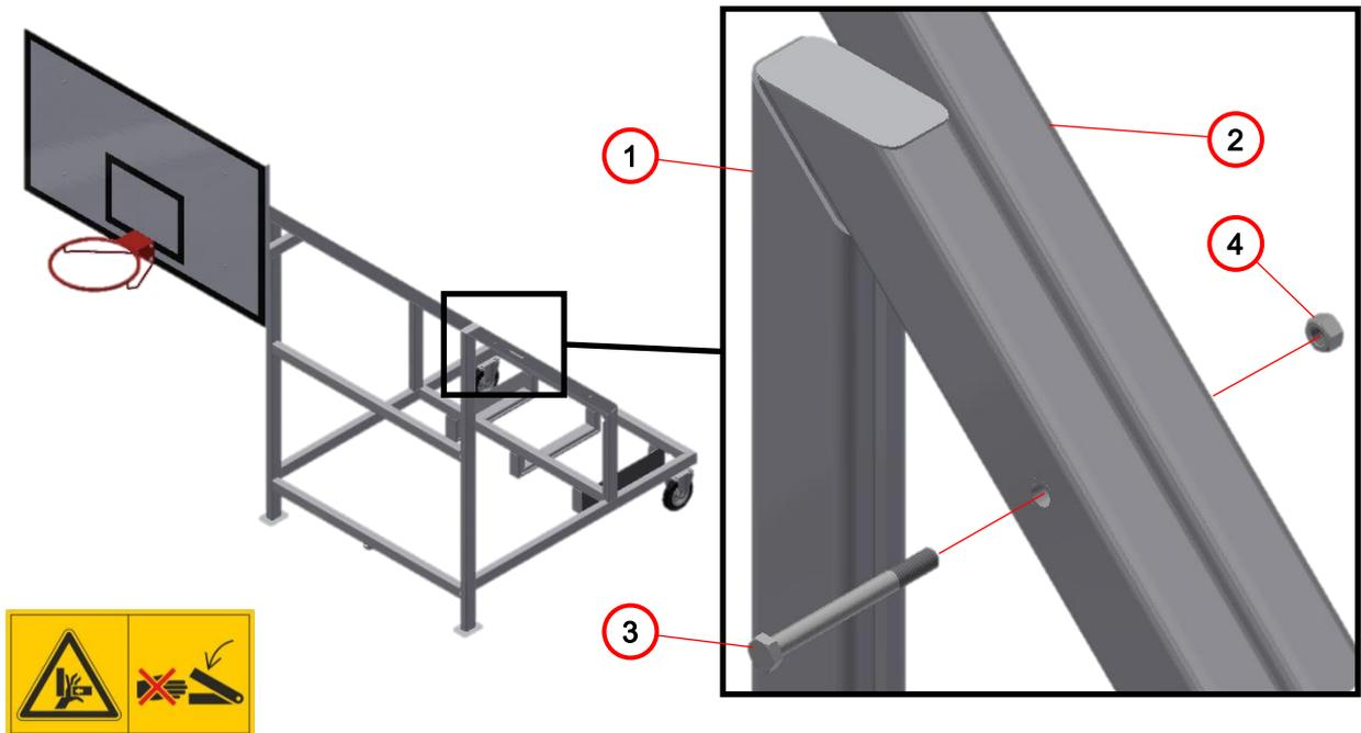
6. Das Korbgerüst (2) aufrichten und an den zwei oberen Punkten vor dem Umkippen sichern. Dafür die Sechskantschraube M12x120 (3) und die Sechskantmutter M12 (4) verwenden.
