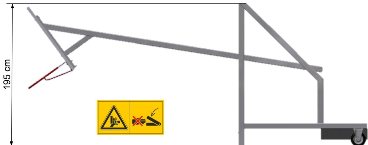
7. Durch lösen und herausziehen der oberen schrauben kann der Basketball-Korb wieder gesenkt werden und durch 2m hohe Doppel-Flügel-türen geschoben werden.
