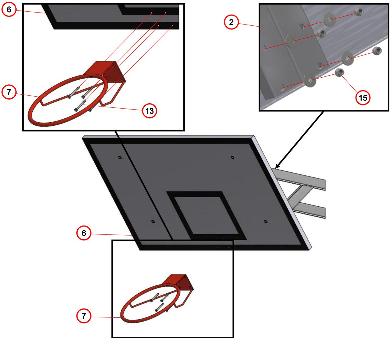
**4.** Den Basketball-Korb (7) an das Zielbrett (6) mit vier Sechskantschrauben M10x90 (13), vier Unterlegscheiben M10 (14) und vier Sechskantmuttern M10 (15) verschrauben.
