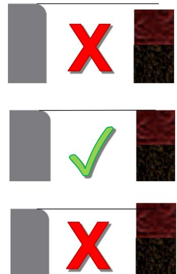
3. Bevor der Beton komplett ausgehärtet ist (der Beton sollte eine dickflüssige Masse haben) die Einbauwanne auf Beton legen und nach der Einbauanleitung ausrichten. Hierbei muss die obere Kante der Einbauwanne eben zur Laufbahnoberfläche liegen.
