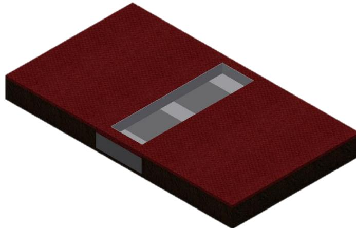
5. Den Beton aushärten lassen und mit Belag, der umgebenden Fläche auffüllen. Danach die Positionsbleche entfernen.
