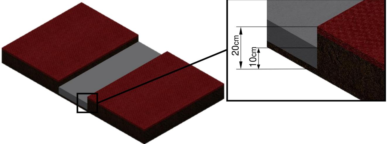
1. In einem 20cm tiefen Aushub, 10cm hoch Beton C20/25 einfüllen. Beim Gießen der Fundamente Drainage zur Entwässerung der Einbauwanne einbauen! z.B. ein Stück Rohr!
