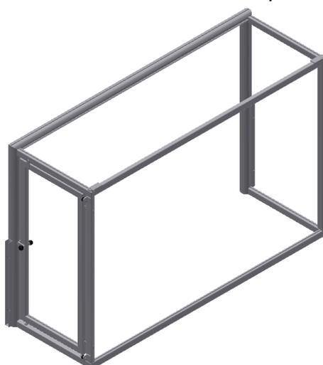
**26.** Mit den KU-Stopfen (24) die größere Bohrung im Holm des Tores verschließen.
