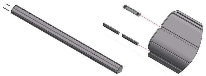
Alternativ können die Nutensteine doppelt M8 auch seitlich in die Profilnut des Gewichtsrohrs eingeschoben werden.
