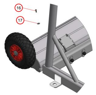
**15.** Die Ache in die Profilnut des Gewichtsrohrs (10) schieben und mit der Linsenkopfschraube M6x16 (16) und der Unterlegscheibe M6 (17) sichern.
