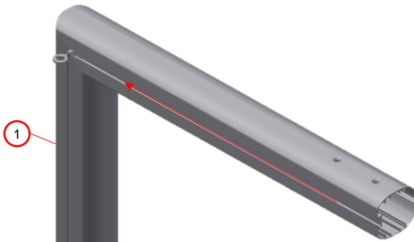
2. Die so bestückte Augenschraube (4) bis in die Torecke des Torpfosten (1/2) schiebe und schrauben diese festschrauben.
