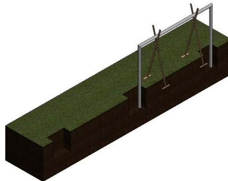
Ein Barriereelement in den Fundamentgruben ausrichten und mit Holzlatten abstützen.
