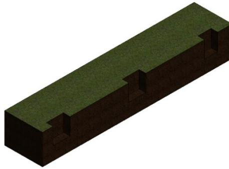
Fundamentgrube für die Pfosten ausheben in den vorgegebenen Abständen (2m).
