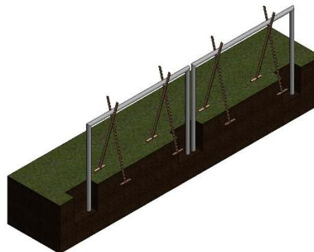
Ein weiteres Barriereelement in den folgenden Fundamentgruben ausrichten und mit Holzlatten abstützen.
