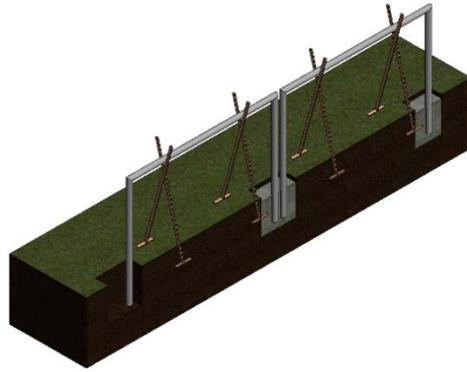
Nachdem die ersten Barriereelemente ausgerichtet sind, können die Fundamentgruben mit Beton (C20/25) gefüllt werden.
