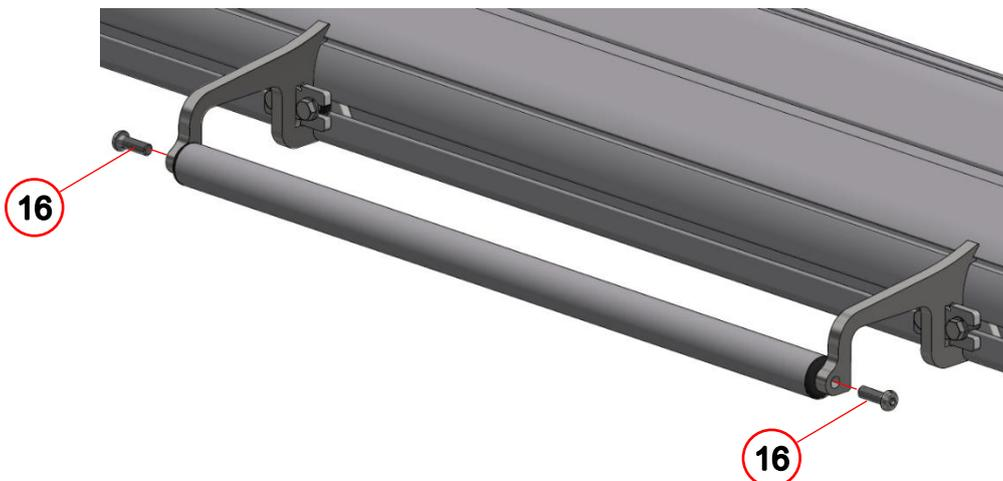
Mit zwei Linsenkopfschraube M8x25 (16) die Griffstange sichern.
