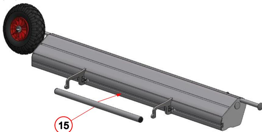
Zwischen beiden Bodenrahmenhaltern die Griffstange (15) positionieren.
